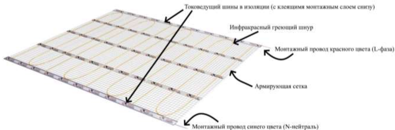
Рисунок 2. Конструкция инфракрасного теплого пола.
