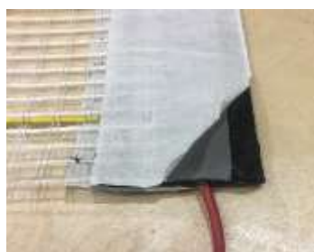
Фото 1. Токоведущие плоские медные шины с выведенными монтажными проводами.
